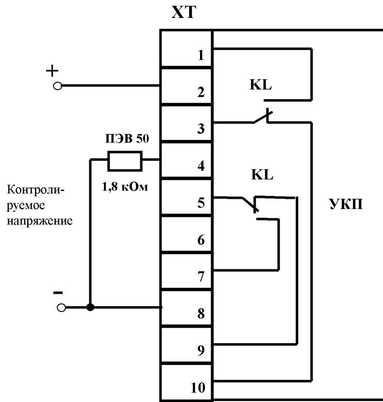
Рисунок А.2 – Схема подключения УКП
